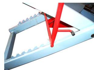
**Seguro mecánico manual:** Permite fijar la rampa a diferentes alturas.
